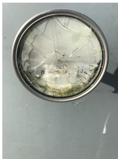
Manomètre défectueux de la cuve d'eau incendie
